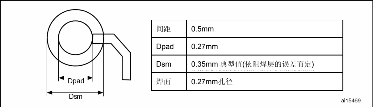
图43 建议的PCB设计规则(0.5mm间距的BGA封装)
