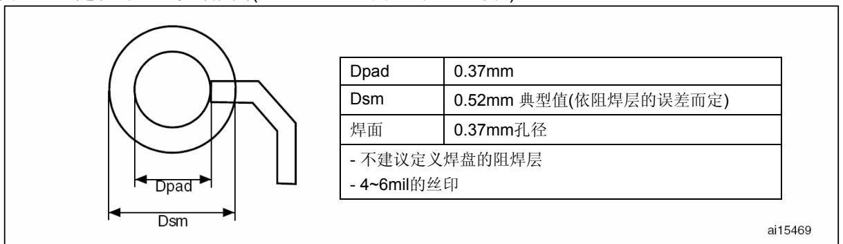
图37 建议的PCB设计规则(0.80/0.75mm间距的BGA封装)
